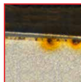
Ataque decapante de las costuras de soldadura. En tijeras de metal duro, pinzas de metal duro y portaguñas Causa: Ataque de ácido por sobredosis del agente químico neutralizador o la aplicación de productos de limpieza básicos.
