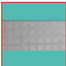
Arrastre de residuos de detergente debido a un aclarado insuficiente
