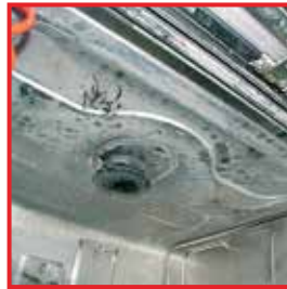
Cámara de aclarado con intensa calcificación
