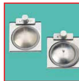
Derecha: Válvula de chapaleta de un trocar no hermética por hinchamiento de la junta, consecuencia del contacto con aceite. Izquierda: Nueva válvula de mariposa
