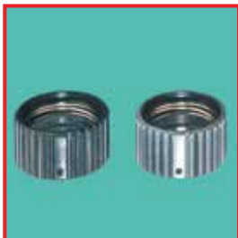
A la derecha de la imagen: Daños provocados por agua descalcificada en el anodizado negro.
