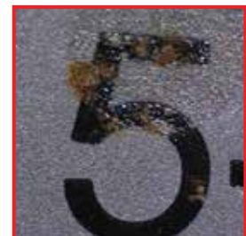
Corrosión de picadura en unas pinzas. Causa: El envejecimiento acelerado de la cinta de código cromático permite la infiltración de sustancias perjudiciales con cloruro.
