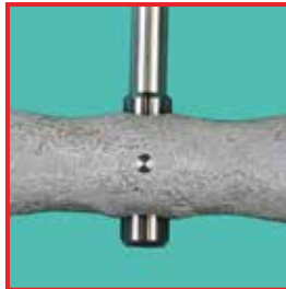
Daños en el revestimiento del mango de aluminio. Causa: producto de limpieza alcalino inapropiado
