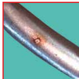
Corrosión de picadura en unas pinzas. Causa: El envejecimiento acelerado de la cinta de código cromático permite la infiltración de sustancias perjudiciales con cloruro.
