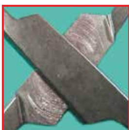
"Corrosión metálica" provocada por la aplicación insuficiente de productos de conservación
