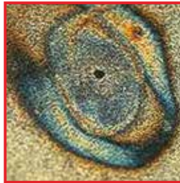
Ejemplo de corrosión de picadura
