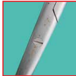
Ejemplo de corrosión de picadura
