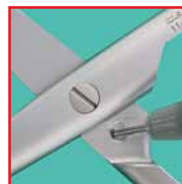
Para evitarlo: Cuidado selectivo con aceite para instrumentos
