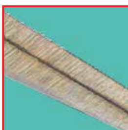
Ataque decapante de las costuras de soldadura. En tijeras de metal duro, pinzas de metal duro y portaguñas Causa: Ataque de ácido por sobredosis del agente químico neutralizador o la aplicación de productos de limpieza básicos.
