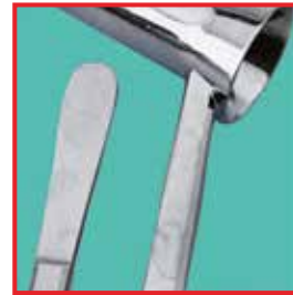
Consecuencia: Instrumentos con restos de cal
