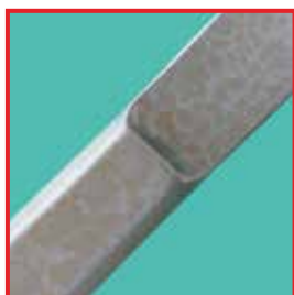
Ejemplo de manchas debidas a impureza en el vapor de condensación
