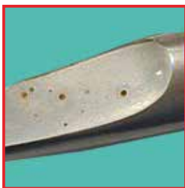
Corrosión de picadura provocada en un instrumento por cloruros.
