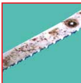
Daños en la capa de cromo parcialmente defectuosa. Causa: La humedad produce una formación de óxido del material base desnudo de acero normal
