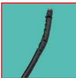
Hinchamiento de un tubo de alimentación utilizando un producto de cuidado inapropiado.
