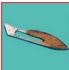
Daños en la superficie de la hoja provocados por la humedad. Causa: Composición del material, acero normal producto desechable.
