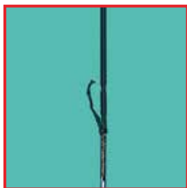
Aislamiento dañado de un instrumento de alta frecuencia
