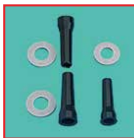
Derecha: Juntas hinchadas como consecuencia de la aplicación incorrecta (no selectiva) de aceite para instrumentos. Izquierda: Nuevas juntas
