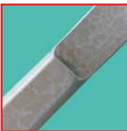
Manchas provocada por los ácidos silícicos en el condensado del vapor.
