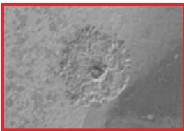
Imagen de microscopio electrónico de barrido, corrosión de picadura inducida por cloruro
