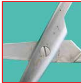
Tijeras con corrosión de picadura
