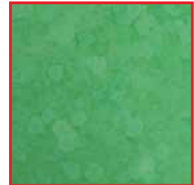
Ataque al material de la superficie de aluminio anodizado natural/ metalizado en contenedores. Causa: solución de lavado con niveles de alcalinidad no permitidos
