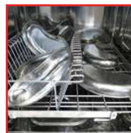
Carga equivocada/bandejas riñoneras volcadas
